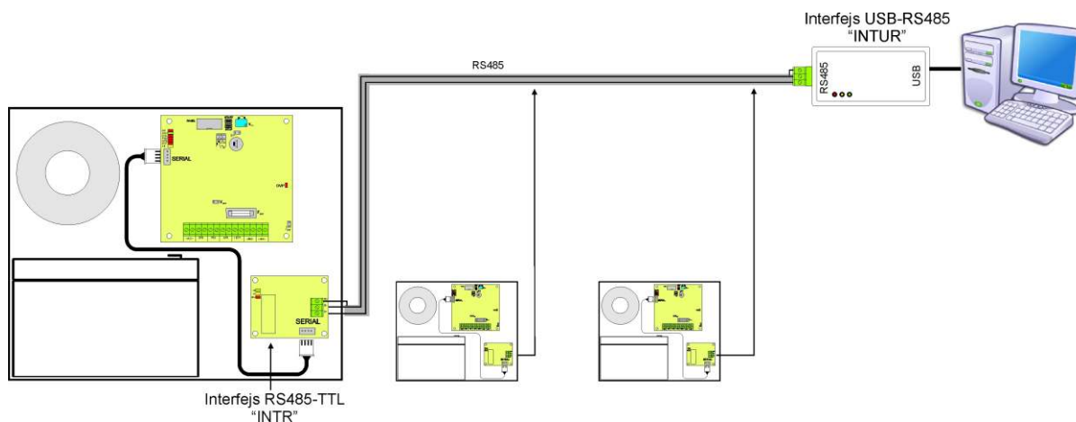
Komunikacja RS485 z wykorzystaniem interfejsów „INTR” oraz „INTUR”.
